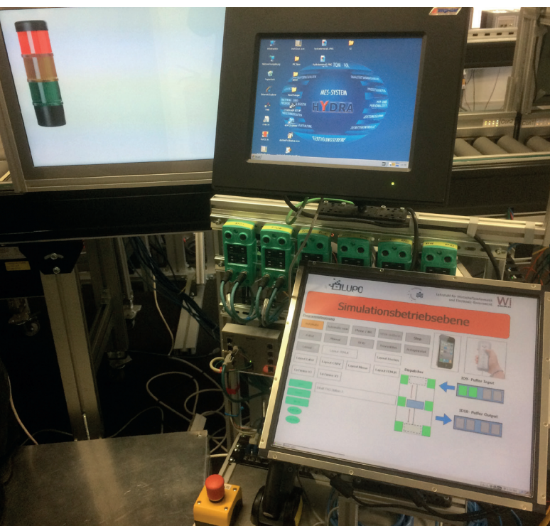
Bild 8: Benutzeroberfläche eines MES (im Beispiel „MES Hydra“). An einem solchen Arbeitsplatz kann der für die Fertigungsabläufe Verantwortliche die vom System festgelegte Reihenfolge der Auftragsbearbeitung sehen. Es ist möglich, Aufträge „zwischen zu schieben“ oder im Bedarfsfall „von Hand“ einzugreifen, falls der Verantwortliche mit der von der Technik geplanten Reihenfolge nicht einverstanden ist.
